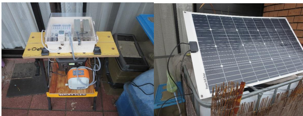
図 3 ソーラー蓄電によるポータブルバッテリー省電力装置の実験状況
