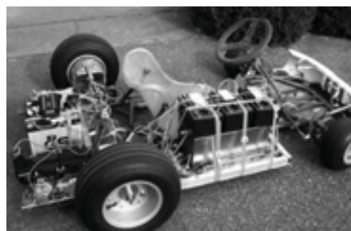
パルス detonation ロケット滑走試験機 “Todoroki” 新形式の航空宇宙用エンジンであるパルス detonation エンジンのシステム実証試験に世界で始めて成功 (Journal of Propulsion and Power, Vol.25, No.1, 2009)
