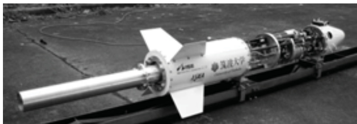
パルス detonation ロケット滑走試験機 “Todoroki” 新形式の航空宇宙用エンジンであるパルス detonation エンジンのシステム実証試験に世界で始めて成功 (Journal of Propulsion and Power, Vol.25, No.1, 2009)
